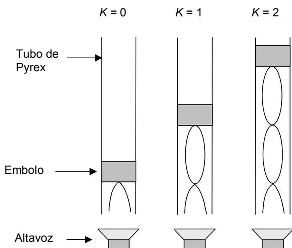
**Fig. 1.** Modos propios de resonancia del tubo para  $K = 0, 1, 2$ .
