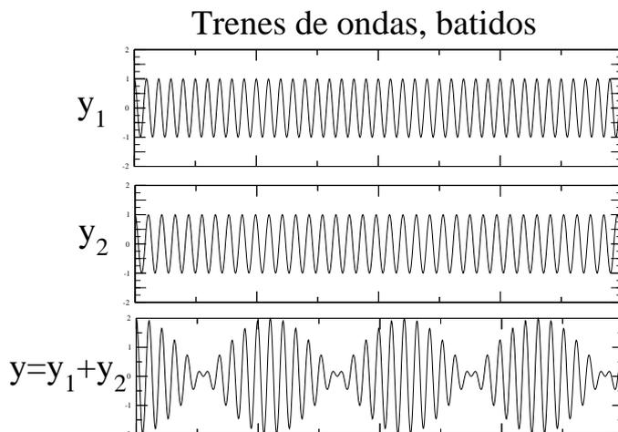
Figura 3: Dos ondas de frecuencias muy similares se superponen, el resultado (figura de abajo) es un tren de ondas con una modulación de baja frecuencia que se conoce como *batidos*
