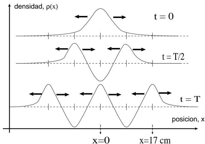
Figura 1: **Onda longitudinal.** Esquema de la propagación de una onda de sonido formada por un repentino aumento de presión inicial ( $t = 0$ ) en  $x=0$ . Las curvas indican la densidad en función de la posición  $x$  y las flechas indican el movimiento de las moléculas del gas por donde se propaga la onda. Los tiempos se indican con respecto al periodo de la onda,  $T$ .
